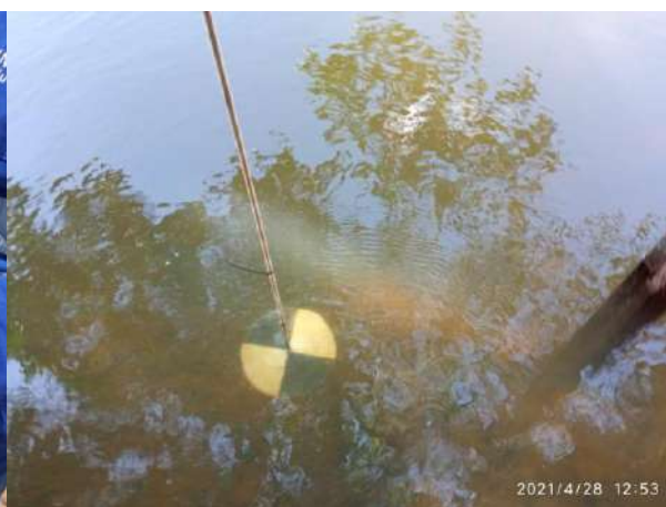
Foto 3.2.1-2. Medição de transparência com disco de Secchi.
