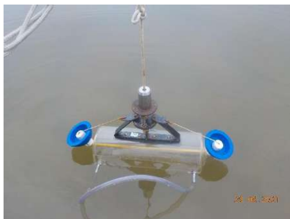
Foto 3.2.1-1. Coleta de amostra de água com garrafa de Van Dorn.
