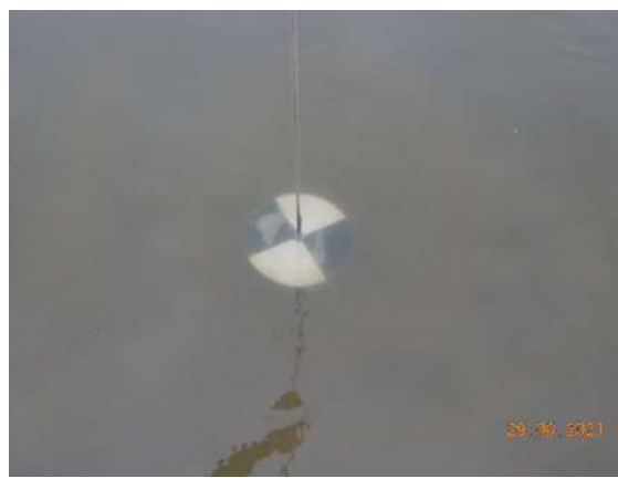
Foto 3.2.1-2. Medição de transparência com disco de Secchi.
